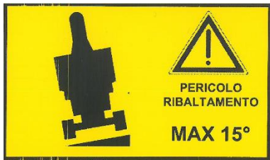
Indication de la pente latérale maximale pouvant être abordée
