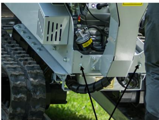
VIS DE RÉGLAGE DE LA TENSION DES COURROIES
