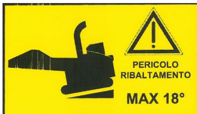
Indication de la pente frontale maximale pouvant être abordée
