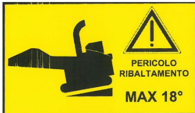
Anzeige der maximalen Frontalneigung
