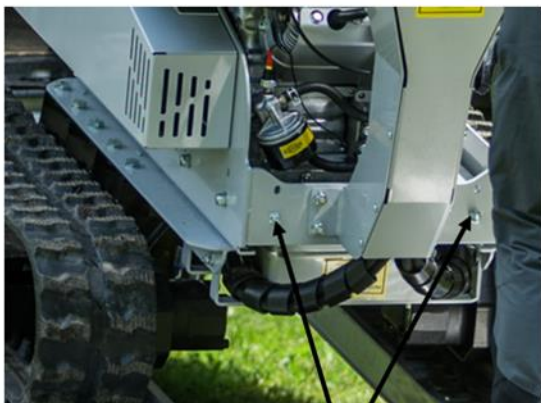
SCHRAUBEN ZUR EINSTELLUNG DER RAUPENKETTENSPPANNUNG
